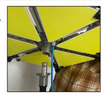
Anschließend den Rastbolzen ziehen und dann wieder loslassen, sobald die Leuchte auf dem Zapfen nach ganz unten gerutscht ist. Dies verhindert, dass der POWERMOON® vom Zapfen rutschen kann.
