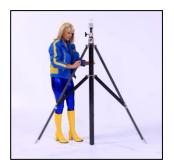
4.6.4 Der Teleskopmast in der Mitte darf den Boden nicht berühren. Den Teleskopmast so einstellen, dass er sich mindestens 10cm über dem Boden befindet.
