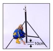
4.6.5 Die Querstreben so einstellen, dass sie parallel zum Boden verlaufen
