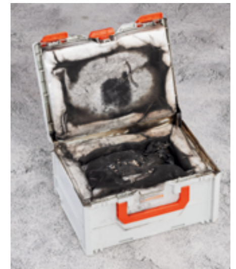
Erfolgreicher Brandversuch: die CEMO Brandschutzbox hält.
